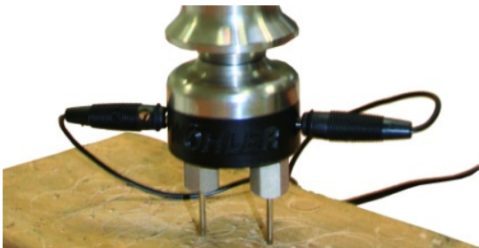
Abb. 9: Anschluss des Verbindungskabels an die Einschlagsonde
