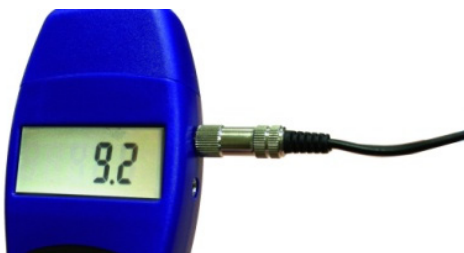
Abb. 10: Anschluss des Verbindungskabels an das Wöhler HBF 420
